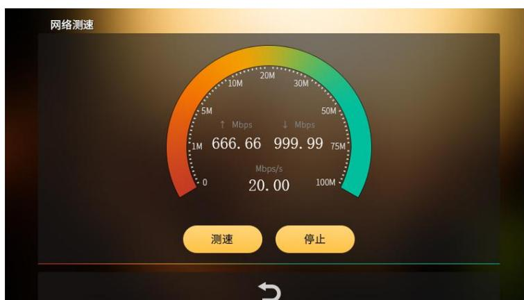
在网络测速界面可实时对当前聚合网络进行测试，可分别设置开始和停止测速。点击最下边的“↶”按钮，返回设置界面。
