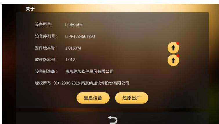
在设备信息界面可查看设备序列号和软件/固件版本信息。如果有推新版本，界面上有升级按钮提示可进行固件升级和软件升级，点击更新按钮，弹出界面如下图所示：
