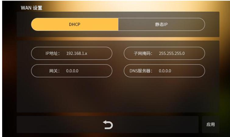
在 WAN 设置界面中可选择动态分配 IP 或者手动设置 IP；选择“静态 IP”设置后，请手动输入 IP 地址、掩码、网关和 DNS。点击“应用”按钮为设置生效，点击最下边的“
