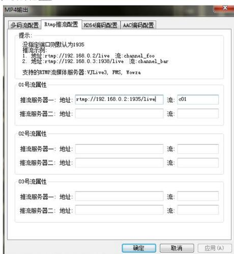
可以推流到 FMS/VJLIVE/WOWZA 等 Flash 流媒体服务器，也可以推流到直播服务器 VJIMS。每条码流可以设置推流 2 台服务器，总共 3 条码流可以推流到 6 台服务器。
