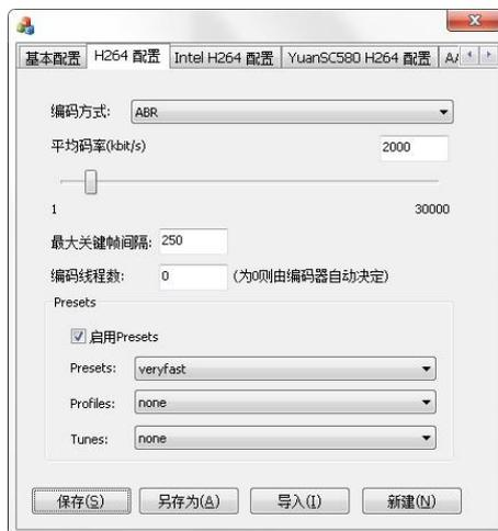
Intel.H264 配置：可以设置编码方式、恒定码率、关键帧间隔、B 帧、Presets 设置。
