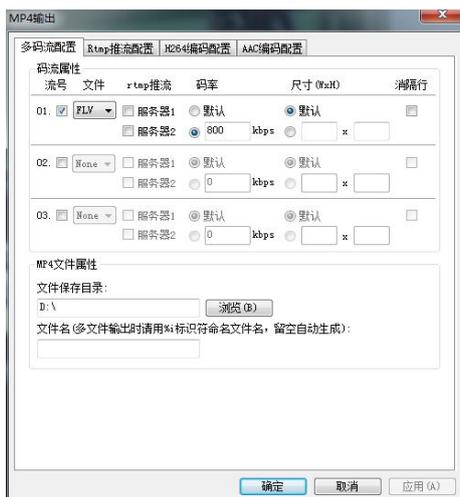
多码流支持 3 条码流，分别对应 01、02、03，每条码流可以分别设置是否录制 MP4、FLV 文件，是否 RTMP 推流（同时支持两个服务器）、码率、画面尺寸、是否消除隔行。
