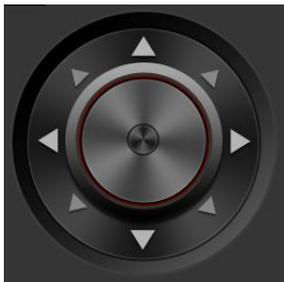
定位操作盘用来控制摄像机电机达到定位目的。最外圈的八个方向(左/右/上/下/左上/左下/右上/右下)三角箭头点击可以执行相应的动作。圆盘中心的圆圈是用鼠标点中不放, 可以进行 360 度拖动, 实现摇杆的作用。此功能可以用来快速操作云台定位。
