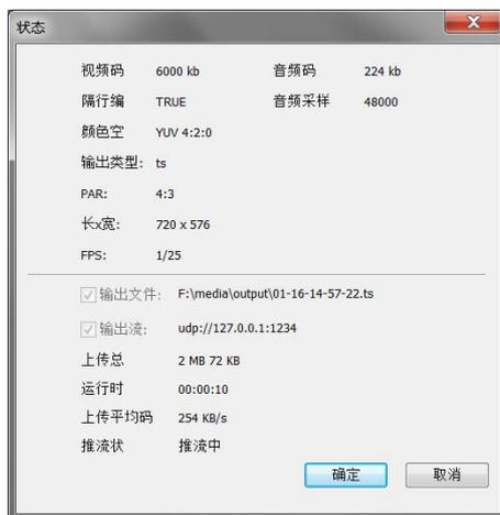
3) MP4 直播：采用 H.264/AAC 编码输出视音频信号,可以保存为 MP4、FLV 文件，同时也可以通过 RTMP 协议推送流到 VJLive3、FMS、WOWZA 进行网络流媒体直播。
