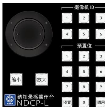
可以通过键盘的 RS232 或者 485 控制摄像机云台的推拉摇移。云台控制部分可以单独使用可以与软件联动使用。
