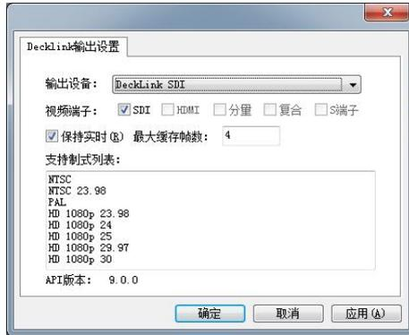
配置完输出设置后，点击开始按钮进行输出卡输出，在开始输出后，可以点击状态按钮查看 Decklink 输出信息。
