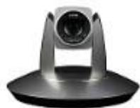
学生全景摄像机，主要作用是拍摄学生全景和学生特写视频，采用云台一体高清会议级摄像机，摄像机支持 H.265 编码、双码流多级别视频质量配置；采用全高清全数字 1080p60 视频输出，214 万像素，1/2.8 英寸 CMOS 传感器；具有 HD-SDI，HDMI 等高清视频输出接口，40 倍变焦(20 倍光学, 12 倍数字)；精密蜗杆转动，定位精确，运行平稳；多种协议及多种控制接口；智能曝光有效解决投影、电视等设备对拍摄人物的影响；支持桌面安装、吸顶安装、壁挂安装，吊杆安装四种安装方式。
