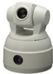
内置业界领先的人体检测及锁定跟踪图像算法，全自动跟踪，无需外接跟踪主机和辅助摄像头；一体化集成设计，可同时输出最高达 1080P60 的特写画面 SDI 视频和网络视频；支持 H.264 编码，主辅双码流；具备教师身高自适应功能，跟踪范围可覆盖全部教室，不再局限于讲台，即使目标走到学生中间也可保持跟踪；极强锁定和抗干扰能力，即使目标长时间静止也能始终锁定跟踪目标，不被其他运动目标或投影仪内容干扰；摄像机内置智能导播切换策略，支持多种跟踪模式，跟踪平稳，目标小幅走动、手部动作等都不会造成摄像机晃动，且动作灵敏度可调节；摄像机水平、垂直均能跟踪，始终保持图像清晰，杜绝虚焦镜头；根据目标远近，跟踪摄像机将自动变倍，始终保持合适大小；跟踪效果不受教室大小、形状和阶梯教室影响；智能曝光功能，彻底避免投影仪等强光背景下跟踪目标变暗问题；可直接在图像上用鼠标框选设置讲台优先跟踪及屏蔽区域；目标出现、丢失等切换码可通过参数设置界面任意自定义；友好的用户界面和极简单的参数设置，便捷安装和使用。
