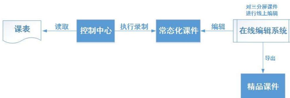
如图所示，云录播系统自动化录制出常态化课件（不添加任何修饰的课件），在个人中心即可启动在线编辑软件，对课件进行片头、片尾、课件信息、视频编辑（打点、替换等）、PPT 编辑、多流的切换等操作，从而将录制出的三分屏课件编辑成为纯视频的精品课件。
