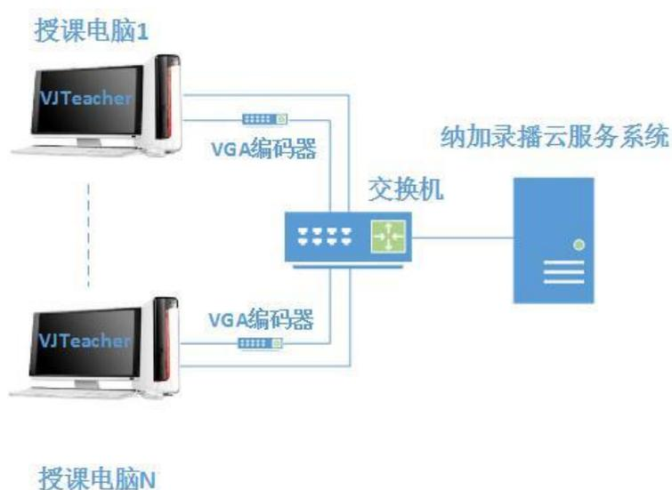
对于 VGA 桌面的采集，有两种采集方案，一种是采用 VGA 编码器硬件，一种是在教师授课电脑上安装 VJTeacher 软件的方式进行采集，两种方式可以组合部署也可以单独部署，组合使用时两个设备一软一硬互为主备，当其中一路采出现中断时，系统会自动启动另一条线路进行采集，以保证 VGA 信号的稳定采集。
