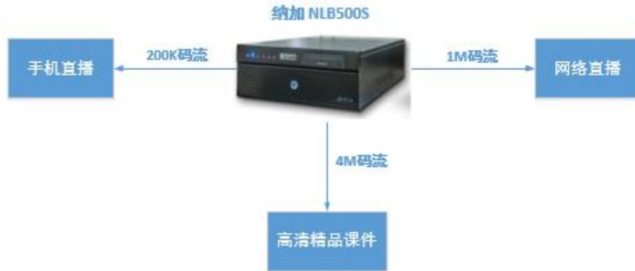
采用纳加三码流并推技术，兼顾本地存储、远程网络和手机端的传输，三码流在现有网络瓶颈下兼顾了图象质量和传输质量，可以突破网络瓶颈，根据网络带宽灵活选择码流格式，达到本地高清视频课件的存储以及再利用，同时通过后端同步录制的低码流进行手机网络传输，确保网络直播和点播应用的流畅。
