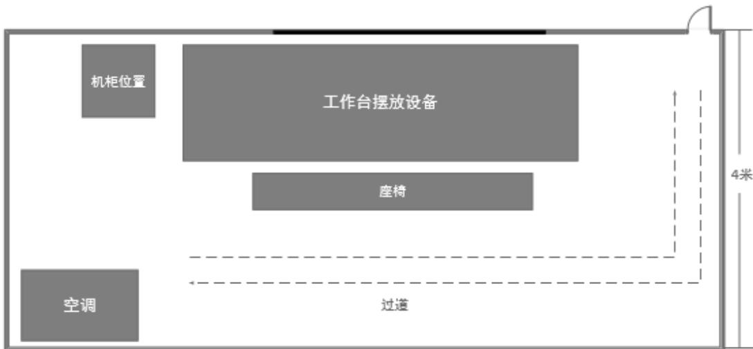
控制室的长度应不小于4米，室内经配备工作台、机柜、座椅等基本常用设备，空调也是控制室内必不可少的设备，要保持室内温度，不易过高以免造成设备损坏或发生火灾等事故。室内温度机柜内主要摆放的设备布线要遵循标准的布线规则，整齐划一、每个设备的进出线都要求要打上标签，机柜门上要张贴机柜内设备的布线连接图。以方便工作人员在调节功能或查找故障时核对具体的设备接口及位置。室内过道要保持通畅，备有灭火器等防火设施。
