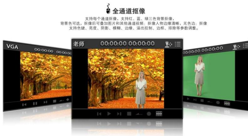
支持每个通道抠像，支持红、蓝、绿三色背景抠像，背景色可选，抠像后可叠加图片和其他通道视频；抠像人物边缘清晰，无色边；抠像支持色键、亮度、阴影、模糊、边缘、溢出控制、边框、排除等参数调整。
