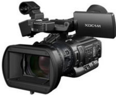
手持式 XDCAM 摄录一体机采用三片 1/2 英寸 Exmor™ CMOS 成像器，实现了高灵敏度和低噪声性能，可记录 XAVC Intra 和 XAVC 长 GOP 格式、以及传统的 MPEG HD 422 50 Mbps、MPEG HD 420 35 Mbps、MPEG IMX 和 DVCAM 格式。作为 PMW-EX280 的接替产品，PXW-X280 具有很多引人注目的特性，包括可实现同步录制的双 SxS 存储卡槽、缓存录制功能，“慢动作和快动作”功能，3.5 英寸 QHD (960 x 540) 彩色 LCD 屏和 17 倍 Fujinon 专业高清变焦镜头，该镜头具有三个独立的控制环，带物理止点，变焦范围是 29.3mm 到 499mm (35mm 等效转换下)。内置了无线操作功能，可通过智能手机和平板设备实现远程控制、文件传输、视频预览以及流媒体功能。
