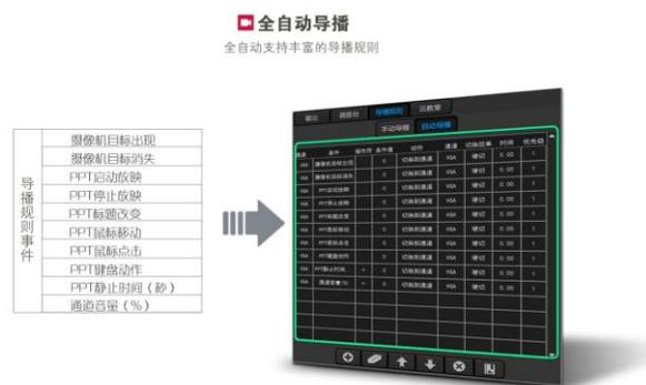
全自动支持丰富的导播规则，包含以下规则事件：学生站立与坐下、学生特写、老师目标出现与丢失、老师上讲台、老师下讲台、老师板书、PPT 启动/停止放映、PPT 章节切换、授课机键盘/鼠标动作、授课机白板动作、授课机空闲时间、通道音量变化等。
