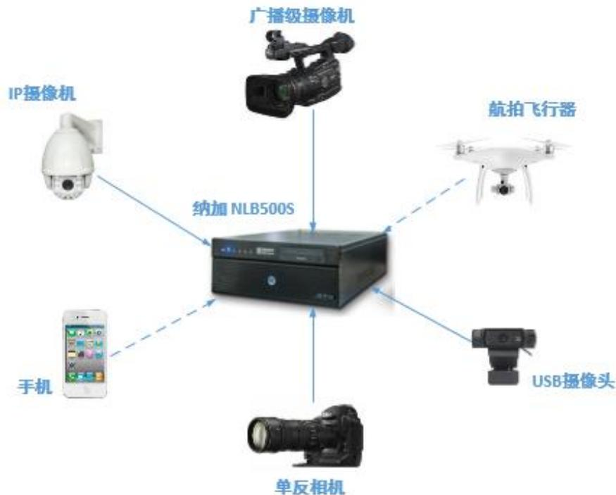
支持全信号源设备接入，专业摄像机、安防监控摄像头、单反相机、手机镜头，无人航拍机，USB 接口摄像头等所有信号采集。
