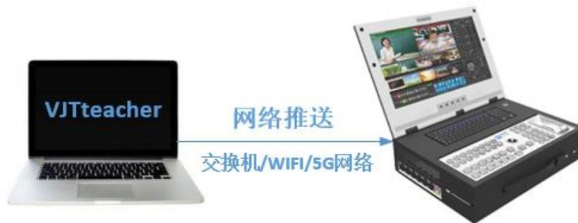
Vjteather软件是专门为采集授课电脑的屏幕而设计，设计模式为软件安装在授课机电脑系统中，通过策略抓取到电脑的屏幕视频，编码后通过网络推送到便携一体机，这样一来授课机的电脑和便携一体机之间只要通过网络互通就可以实现电脑桌面的采集了。系统支持多个客户端同时采集一台电脑的VGA屏幕，采集的画面清晰流畅，CPU和网络使用率极低，基本不影响教学。采集的内容没有限制，只要是在电脑桌面上运行的程序包括网页、PPT、视频、桌面等所有信息都能够采集。采集的最高分辨率为1920×1080，与当前主流的1080P摄像机的分辨率相同，这样也有效的保证了导播录制视频中各流之间的协调性。对于PPT的录制，系统支持PPT章节的自动抓取，可根据章节的标题自动同时生成时间线打点索引和缩略图索引，方便课件的观看。
