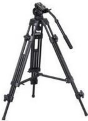
表面采用高强度铝合金材质，经特殊工艺处理，确保户内外长久拍摄不褪色；55MM 碗径体阻尼云台，确保摄像机平滑转动，面板防滑保险，有效防止摄像机意外滑落；两段式可调手柄，人性化设计两侧都可以安装手柄，竖直方向锁紧手钮，满足云台+70° 和-90° 俯仰拍摄定位；水平锁紧手钮，满足 360° 全方位拍摄，内置水平珠，确保拍摄质量；3 段式脚架，满足不同拍摄时的高度调节；
