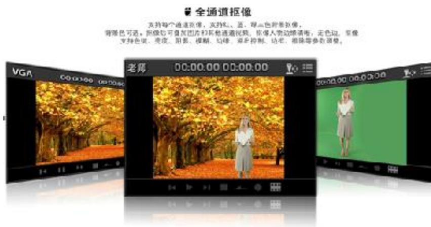
支持每个通道抠像，支持红、蓝、绿三色背景抠像，背景色可选，抠像后可叠加图片和其他通道视频；抠像人物边缘清晰，无色边；抠像支持色键、亮度、阴影、模糊、边缘、溢出控制、边框、排除等参数调整。
