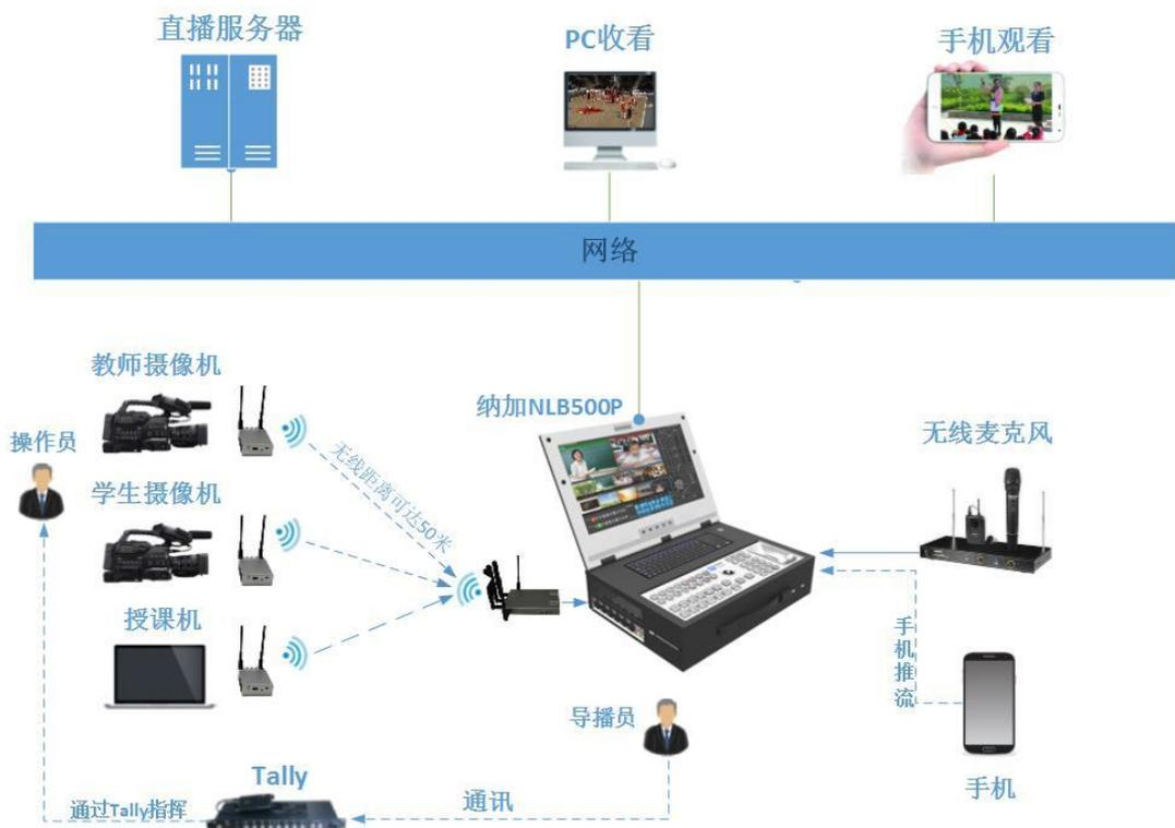
方案特点：方案采用广播级专业摄像机，该摄像机需要人工进行操作，镜头的推拉摇移由专门负责摄影的人员负责，用户具有符合要求的摄影团队，导播员通过 Tally 通讯系统可协调各机位的操作人员进行机位镜头的调整，最终通过导播切换完成广播级的视频录制和直播任务。特定场所可通过纳加便携式录播主机上的云台控制摇杆对摄像机进行控制，这种现
