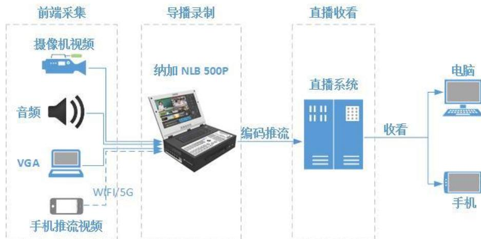
系统主要由前端采集系统、导播录制系统、直播系统组成，其中前端采集系统包括摄像机、无线麦克风主要完成音、视频的采集功能；导播录制系统是本系统的核心系统，主要负责将采集到的音、视频合成纯视频、三分屏课件，同时将音、视频编码推流到直播服务器；直播系统将音视频流通过 P2P 的方式转发至网络终端进行观看，非网络延时小于 1 秒；为了便于携带本方案中量身定制了拉杆箱，现场人员可方便的将设备移动到活动现场。
