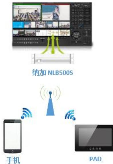
支持在 Android 和 iOS 平板上远程控制多台录播主机，支持自动、手动导播切换，支持云台自动跟踪、手动跟踪切换；支持所有摄像机远程云台控制、云台速度调节、预置点调用和保存；支持音量 VU 条监视和增益调节；支持录制开始、暂停、停止控制；支持直播开始、停止控制；支持录播机系统资源实时监看；支持多台平板控制一台录播
