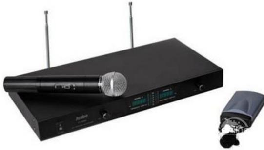
高质量无线麦克风采用经典成熟的发射接收电路，可靠性高；采用独特导频技术，可满足多套同时使用；特设接收灵敏度调节功能，拾音距离可调；话筒采用 1.5v×2 电池供电，具有低功耗，电池易于采购等优点；接收机采用 12V 直流供电，安全可靠了；LED 面板，可显示话筒频点信息，产品每套设备配备一个领夹麦克风和手持麦克风，适用于佩戴或者手持方式采集音频。
