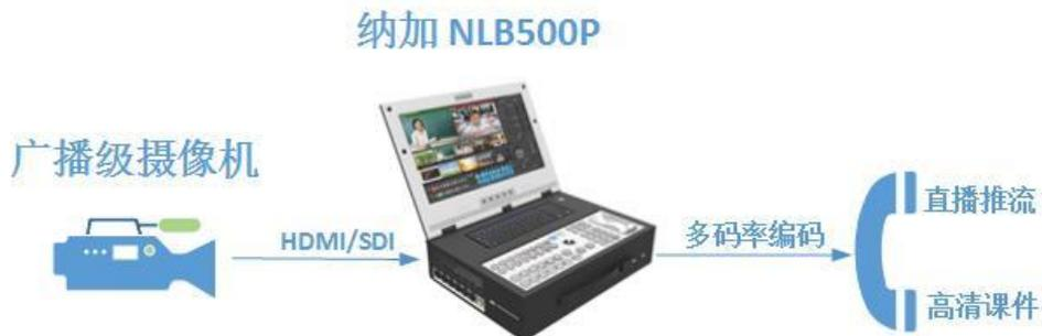
系统设计从前端采集到编码推流都注入了广播级的概念，摄像机镜头采用当下主流的三片 1/2 英寸 Exmor™ CMOS 成像器，色彩还原度、图像清晰度都是广播级的效果，传输环节选择 HDMI/SDI 数字链路，减少中间转换环节也就减少了图像在传输环节中的损失，编码环节采用纳加经过十几年积累的以 H.264 为基准的优化算法，最终生成广播级的高清晰视频文件和视频流。
