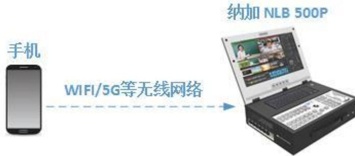
手机对流 APP 功能是纳加公司研发团队自主研发，主要功能是将移动终端手机、ipad 等移动终端做为采集端，并将采集到的视频推流到服务器，从而达到采用移动终端来完成音视频互动的目的。该功能的出现使远程互动的相关应用变得更加灵活、方便。
