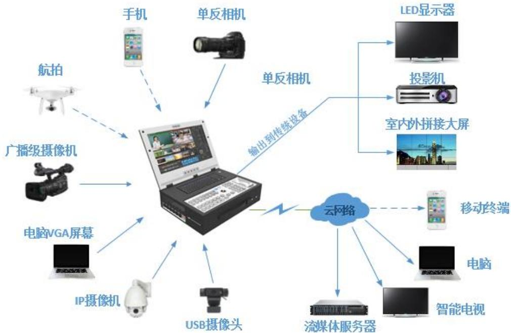
支持全信号源设备接入，专业摄像机、安防监控摄像头、单反相机、手机镜头，无人航拍机，USB 接口摄像头等所有信号采集。可通过硬件和网络输出到各种显示屏和网络应用设备完成各种场所的直播、点播、互动应用。
