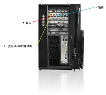
所有 SDI/HDMI 输入支持内嵌音频,另外提供两路 2 路大三芯平衡立体声输入用于(其中第 1 路输入支持幻象电源给麦克风供电),2 路大三芯平衡立体声输出。
