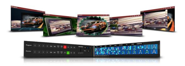
NSCaster 351 支持多机位带特技切换,支持通过 T 杆、键盘、鼠标切换;支持 PVW 切换预览,支持 FTB 切黑场;内置擦除、滑行、卷页、溶解、伸缩、画中画、3D、交换等超过 200 多种特技;带有切换效果编辑器,用于创建和编辑切换特技。
