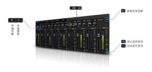
内置专业软调音台,支持每通道 VU 监视和增益调节,支持 dBVU/dBu/dBrS VU 制式,每通道音频可以单独调音和开关,支持锁定一路音频作为输出,支持素材通道独占音频输出,支持音频跟随切换通道;支持各通道音频独立监听;支持左右声道平衡设置,支持单声道转立体声。
