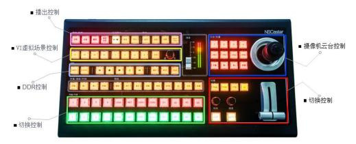
外置专业导播操作键盘,更符合导播人员操作习惯。支持切换、DDR 控制、VI 虚拟场景控制、播出控制、字幕控制、摄像机云台控制等操作,支持 TALLY 信号输出。
